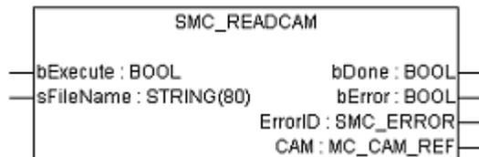
Die Größe einer ladbaren Kurvenscheibe wird begrenzt durch die globalen Konstanten gc\_SMC\_FILE\_MAXCAMEL (Anzahl Elemente) und gc\_SMC\_FILE\_MAXCAMTAP (Anzahl Nockenschaltaktionen).
