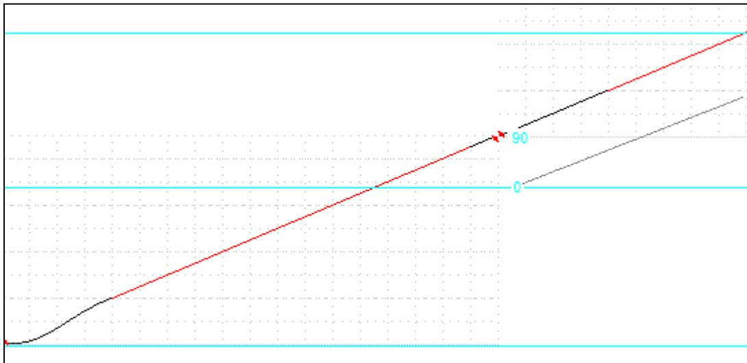
Dann stünde beim Übergang von Kurve1 und Kurve2 der Slave auf Position 90. Würde man jetzt Kurve2 im Modus absolute starten, würde sich die graue Kurve und damit ein Positionssprung ergeben. Man könnte sich aber z.B. dadurch behelfen, dass man einen entsprechenden Slave-Offset von 90 programmiert.
