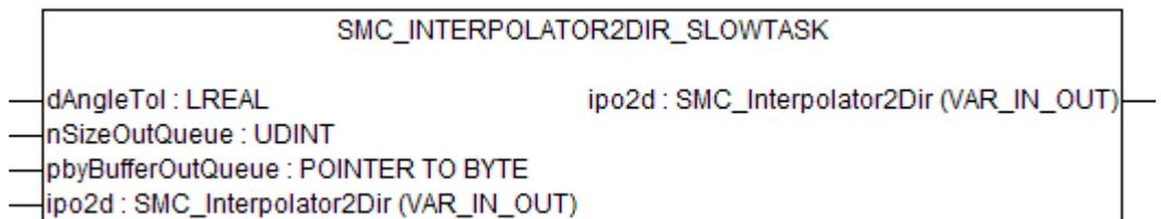
Dieser Baustein ist für das Erzeugen des Rückwärts-Pfades verantwortlich. Er wurde von SMC\_Interpolator2Dir abgespalten, damit er auf stark ausgelasteten und weniger performanten Zielsystemen in eine nieder-priore Task ausgelagert werden kann.
