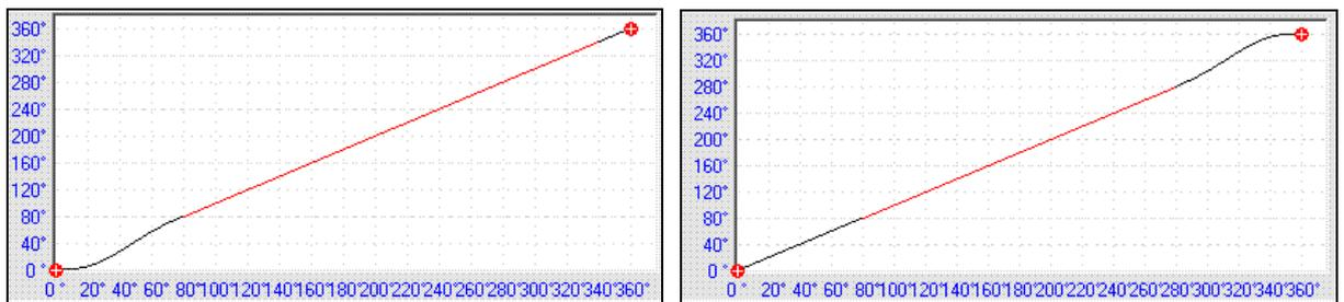
**(1)** Die Geschwindigkeiten und Beschleunigungen des Endpunkts der letzten Kurve und der neuen Kurve sollten übereinstimmen, um Sprünge und Rucks zu vermeiden. Das ist im Beispiel der Fall: der Endpunkt der Kurve1 und der Startpunkt von Kurve2 haben identische Geschwindigkeits- und Beschleunigungswerte.
