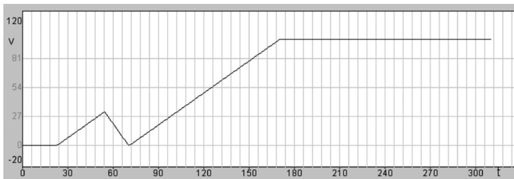
Beispiel eines S-förmigen Geschwindigkeitsprofils (Vel\_Mode = 1):
