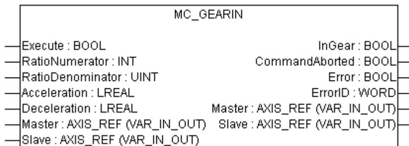
Der Baustein beschleunigt bzw. bremst die Slave-Achse so lange, bis ihre Geschwindigkeit zu der der Master-Achse das gewünschte Verhältnis hat, wobei er die Werte Acceleration und Deceleration benutzt. Ist dies erledigt, leitet sich die Geschwindigkeit der Slave-Achse von der Master-Achse ab.
