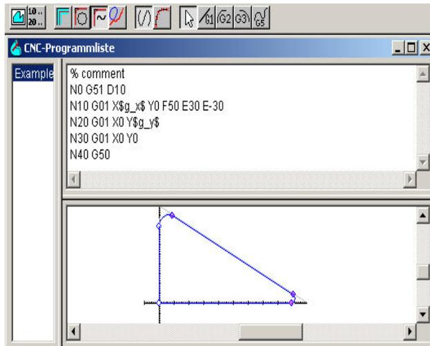
Würden wir keine Variablen verwenden, könnten wir das Programm in dieser Form als Queue übersetzen und direkt in den Interpolator eingeben; da wir aber Variablen verwenden, müssen wir das Dekodieren und die Eckverschleifung selbst durchführen. Deshalb deklarieren wir einen neuen Baustein vom Typ SMC\_SmoothPath und rufen ihn nach dem Decoder auf:
