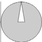
Für einen Rotationsantrieb wird obiges Bild dargestellt. Die aktuelle Position wird durch die Stellung des Pfeils dargestellt und erhält eine blaue Farbe, sobald sich der Antrieb in Regelung befindet. Voraussetzung für die Verwendung des Templates ist, dass der Parameter fPositionPeriod gesetzt ist.
