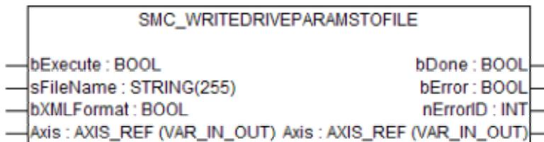
Dieser Baustein liest alle Konfigurations-Parameter des Antriebs aus und speichert diese in einer Datei. Da er einen Dateizugriff durchführt, der evtl. mehrere ms die Abarbeitung der Applikation blockiert, darf er i.d.R. nicht in der Motion-Task aufgerufen werden, sondern sollte in einer niedrigerprioreren Task ausgeführt werden.
