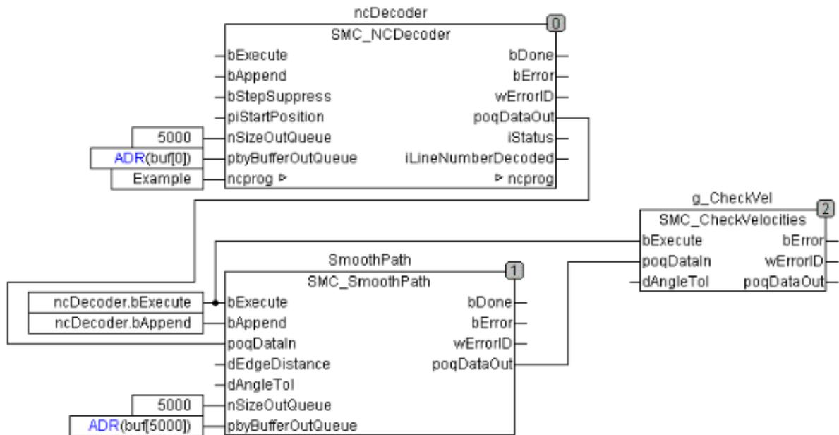
Der Daten-Eingang des Interpolator-Bausteins muss wie immer auf den Ausgang poqDataOut des CheckVelocities-Bausteins gesetzt werden.
