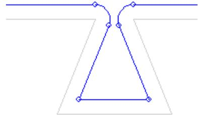
**Folgende Einschränkung sei dabei beachtet:** Ist die Kontur und der Bohrradius so gewählt, dass innerhalb der versetzten Bahn ein Schnitt mit sich selbst stattfindet – d.h. die gewollte Kontur wird beim Befahren der versetzten Bahn zerstört -, so wird darauf keine Rücksicht genommen (siehe Skizze rechts). Um dies zu vermeiden, verwende man den Baustein SMC\_AvoidLoop.
