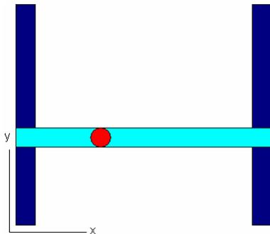
Die Bausteine addieren, da für Portalsysteme keine Transformation durchgeführt werden muss, lediglich Offsets auf die x-, y- und z-Achsen.
