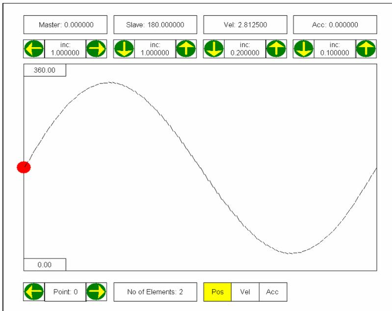
Der rote Kreis markiert den aktuellen Kurvenscheibenpunkt. Dieser kann über die Pfeile unten links gewechselt werden. Über die Leiste unten rechts kann ausgewählt werden, ob Position, Geschwindigkeit oder Beschleunigung angezeigt werden soll. Mit den Pfeilen oben können die Master-, Slave-Position, Slave-Geschwindigkeit und –Beschleunigung um das eingestellte Inkrement verschoben werden.
