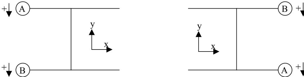
Man beachte, dass für diese Transformation eine spezielle Referenzfahrt nötig ist. Will man, dass eine Bewegung in Y-Richtung erfolgt, müssen die Antriebe A und B gleichläufig bewegt werden; für eine reine X-Bewegung sind diese gegenläufig zu drehen. Hat man die Referenzposition gefunden, verwendet man die vom Vorwärtstransformations-FB errechneten x- und y-Werte als Offset (dOffsetX und dOffsetY).
