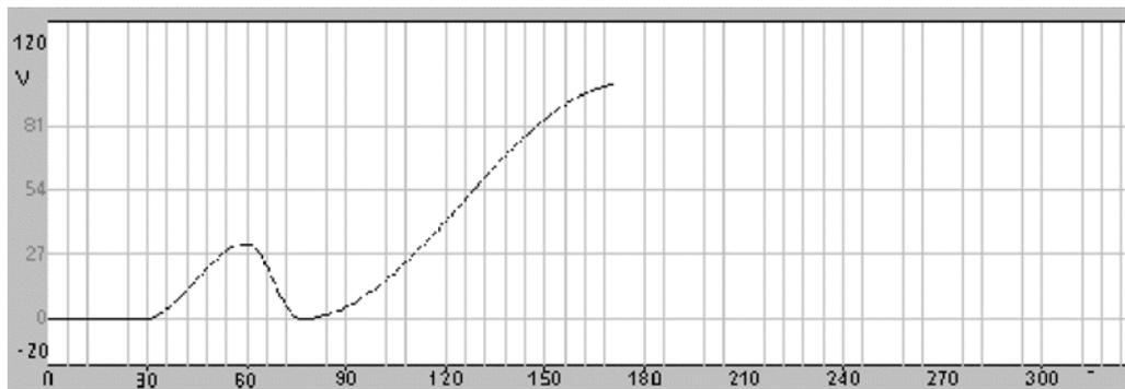
In obigen Beispielen wurde die maximale Beschleunigung (*Accel*) kleiner gewählt als die maximale Bremsung (*Decel*). Dies verursacht die unterschiedliche Steigung der Geschwindigkeit beim Beschleunigen und Bremsen.
