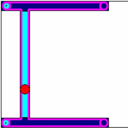
Dieses kinematische System ähnelt den zuvor beschriebenen Portal-Systemen, wobei hier die Antriebe stationär angebracht sind, und den Schlitten und die Y-Achse über einen mehrfach umgelenkten Riemen (im Bild pink) bewegen.
