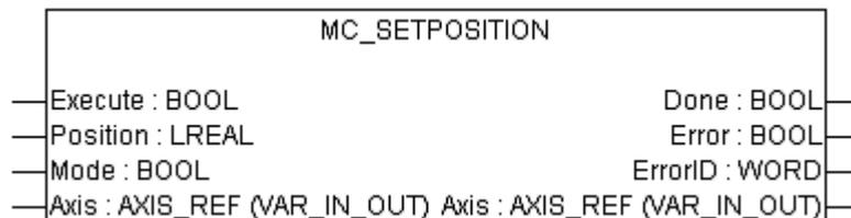
Grundsätzlich kann der Baustein zu jedem Zeitpunkt aufgerufen werden. Man beachte aber, dass bei einer bahngesteuerten Bewegung, wenn die Sollpositionen dem Baustein direkt z.B. über SMC\_ControlAxisByPos zugeführt werden, ein Sollpositions-Sprung entstehen kann.
