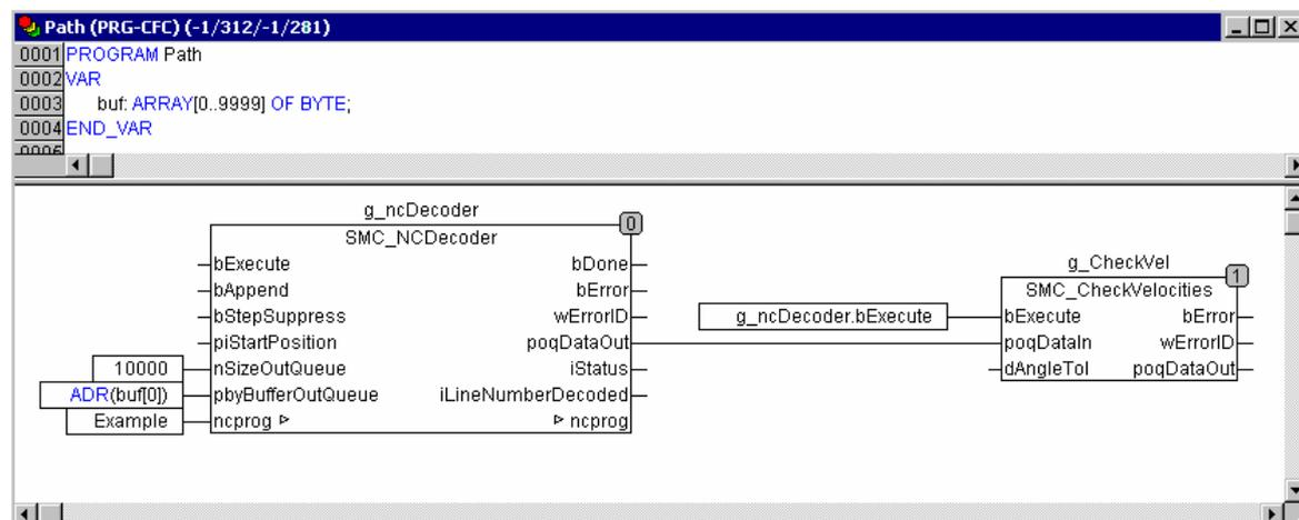
Der interpolierende Teil des IEC-Programms bleibt fast gleich, nur dass der Daten-Eingang des Interpolators nicht wie zuvor dem CNC-Programmnamen (ADR(Example)) entspricht, sondern aus dem OutQueue-Ausgang der bahnvorverarbeitenden Bausteine (g\_CheckVel.pqDataOut) besteht.
